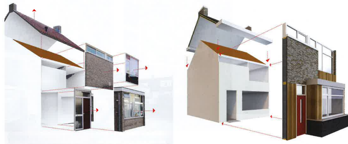
Principe van Built4U. Binnen vijf dagen worden gevel en dak vervangen door een passiefschil
